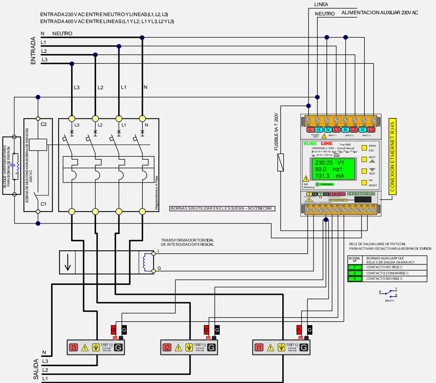
TRANSFORMADOR TOROIDAL DE INTENSIDAD DIFERENCIAL
