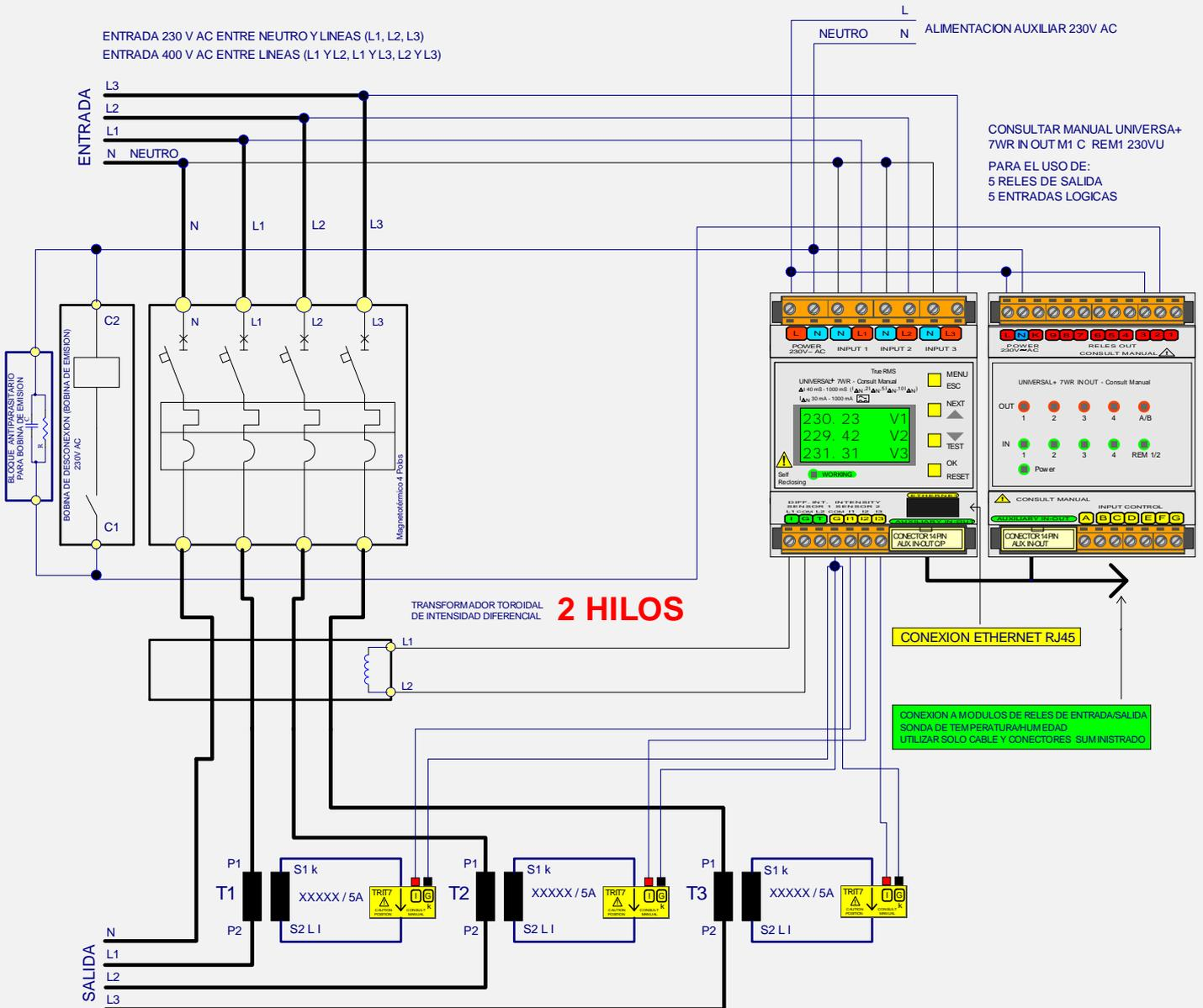
TRANSFORMADOR TOROIDAL DE INTENSIDAD DIFERENCIAL 2 HILOS
