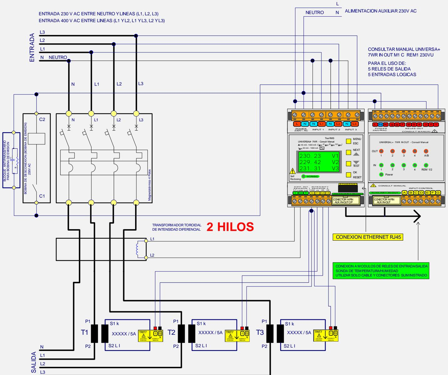
TRANSFORMADOR TOROIDAL DE INTENSIDAD DIFERENCIAL 2 HILOS
