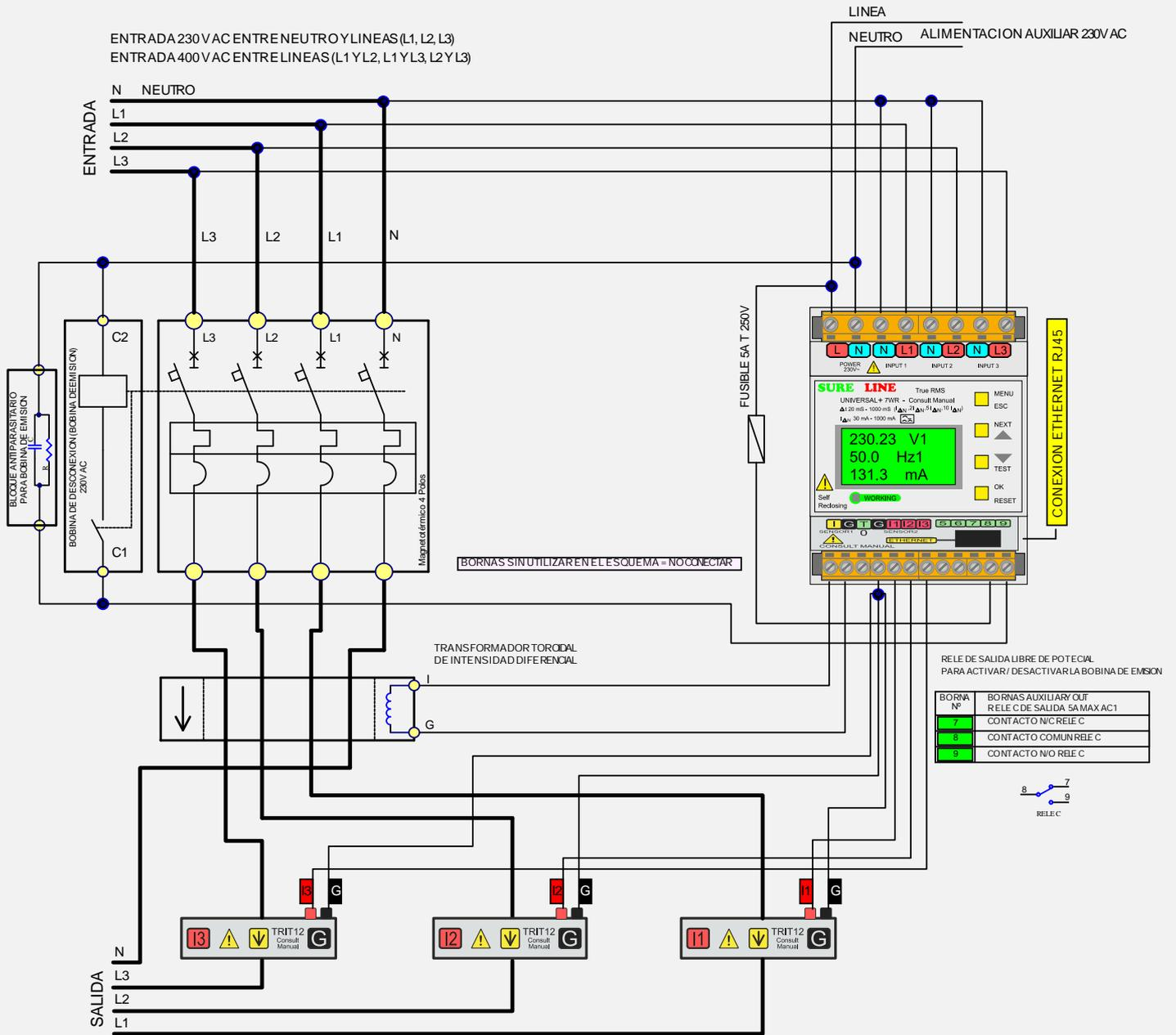
TRANSFORMADOR TOROIDAL DE INTENSIDAD DIFERENCIAL
